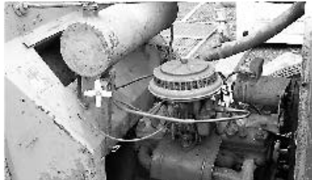
Rostig, aber rüstig: der Seitenventiler des 1,2 Liter. Nicht original ist der Benzinhaahn.
