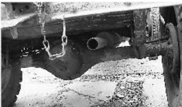
Eine wahrhaft starre Hinterachse – direkt mit dem Rahmen verschweißt
