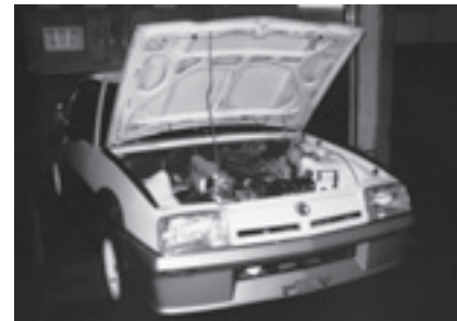
Der A07 beim Umbau vom originalen 2,8-Liter-Motor auf den 3.0E. Hier sind auch noch die originalen Breitbandscheinwerfer verbaut. Die Windsplits auf den Kotflügelkanten sind zeitgenössisches Irmischer-Zubehör
