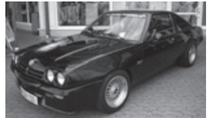
Der A01 im aktuellen Zustand mit 3.0-24V-Motor. Im Original besaß er den 2,8 Liter mit „Schwedenkopf“
