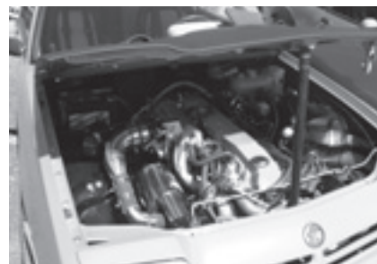
A11 mit originalestem 2.8 ltr. Motor, der jedoch auf die D-Jetronic rückgerüstet wurde. Seit 2007 ist zusätzlich ein Kompressor verbaut
