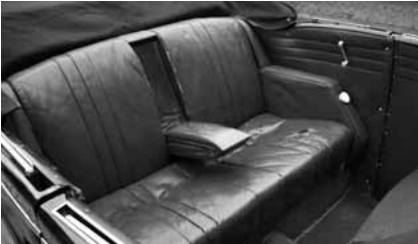
...steckt der Teufel bekanntlich im Detail. Die hintere Sitzbank zeigt Risse, um die Mittelarmlehne sind die Nähte aufgeplatzt
