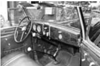
Rechts im Bild ist zu erkennen, dass die Türpappen aufgerollt sind, das Bodenblech links im Fußraum benötigt ebenfalls Arbeit.
