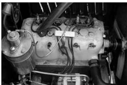
*Von wegen einfach - jeder Zylinder hat einen eigenen Dekompressionshebel! Der Behälter für die Kraftstoffzufuhr links im Bild ist nachgerüstet worden*
