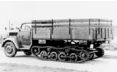
Opel Dreitonner Blitz Maultier mit Kettenantrieb aus dem Jahr 1943
