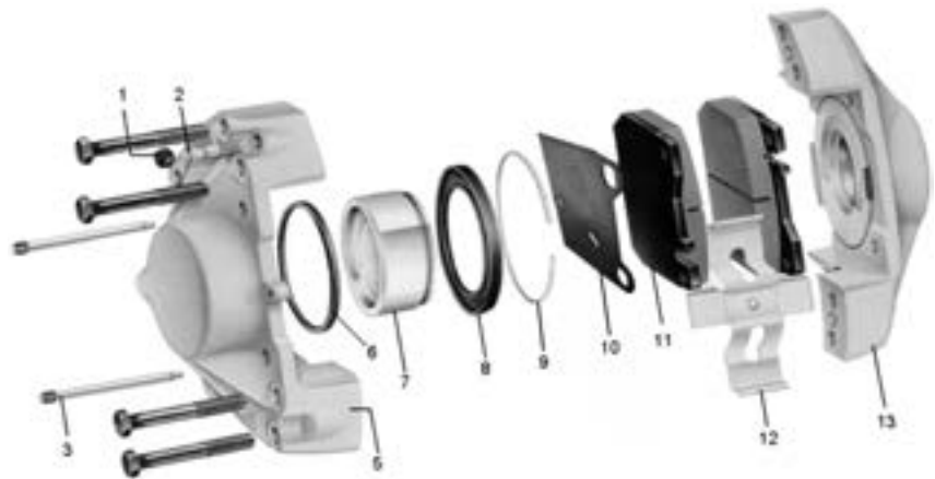
Bremssattel im GT, Kadett B und Olympia A. 7 = Bremskolben, 6+8 = Dichtelemente, 5+13 = Sattelgehäuse, 10 = Opel „Anti-Quietsch-Blech“, 11 = Bremsbelag, 12 = Kreuzfeder
