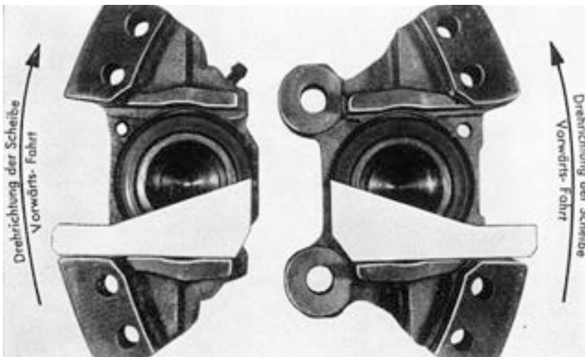
In den geöffneten Bremssattel geschaut: 20° Kolbenlehre, Pfeile zeigen die vorwärts Drehrichtung der Scheibe
