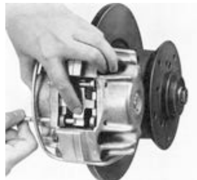
Einsetzen von Kreuzfeder und Haltestifte
