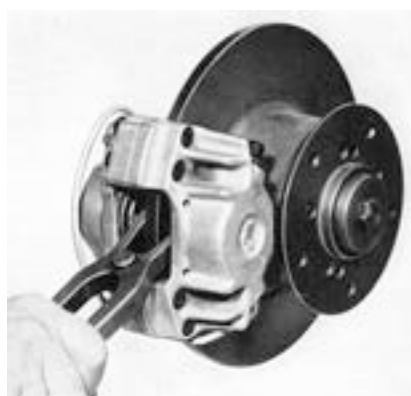
Zurückdrücken der Bremskolben
