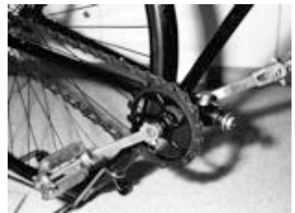
Die Kettenspannung wird bei den ersten, Safety genannten Niederrädern noch am Tretlager reguliert
