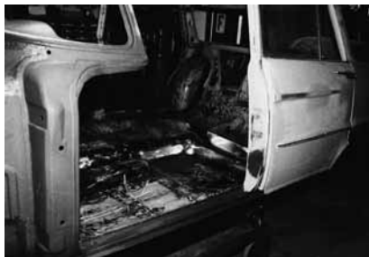
Die erneuerte A-Säule
