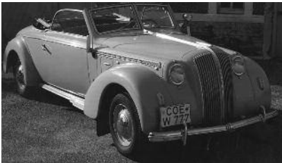
Ein Admiral '38 Gläser Cabriolet heute. Die Türen sind vorn angeschlagen, die Verdeckabdeckung ist auf dieser Aufnahme nicht montiert
