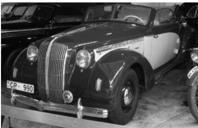
Dieses Cabriolet steht in einem Museum in Osteuropa, vermutlich in Litauen. Auf den ersten Blick erinnert es an ein Hebmüller-Cabriolet. Dafür sprechen die außenliegende Verdeckmechanik und die drei hinten außen angebrachten Türscharniere. Nicht ins Bild passt allerdings der kurz nach der Scheibe abgeschnittene Dachrahmen, ein Merkmal der Gläser-Cabriolets
