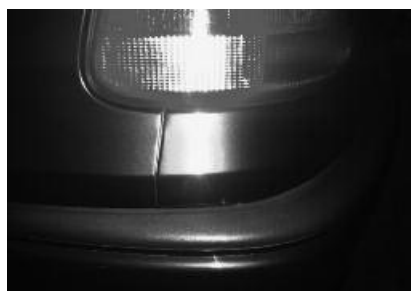
Die Naht unter der Rückleuchte kann rosten, der...
