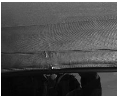
Solche Risse kündigen den bevorstehenden Austausch an
