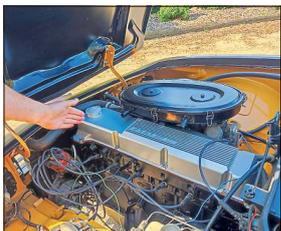
Unter der wichtigen Motorhaube schlägt das Herz des Manta TE 2800: Der Sechszylinder Commodore-Motor leistet 144 PS.
